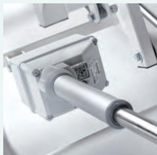
Motore SL95/10000N lavora a 10.000 Newton per movimentare il lettino da 49 a 87 cm in altezza in 14 mm al secondo.
